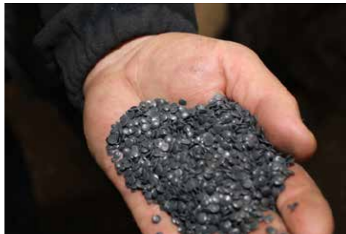
Granulat nastao usitnjavanjem otpadnog polietilena
