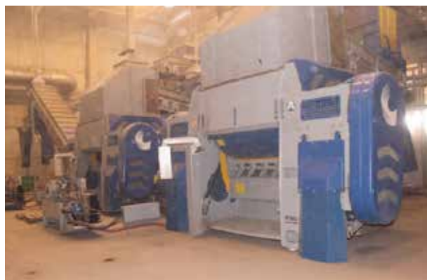
Sekundarni sjekači – proizvodnja goriva iz otpada
