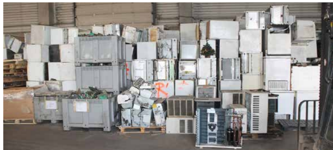
Rashladni uređaji se prije postupka recikliranja moraju skladištiti u suhim, prozračnim prostorima
